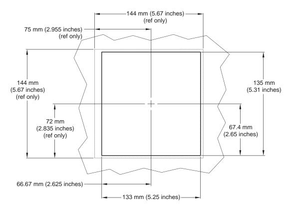
Figure 3-5 Conduit Hole Dimensions
